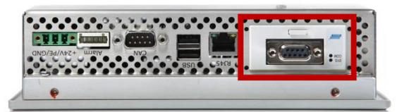
Wenn Sie Ihr Gerät nur mit einem Master ohne weitere Slaves am Bus verbinden, müssen Sie beide Geräte an den Enden des Kabels anschließen, damit die Abschlusswiderstände mit Spannung versorgt werden. Wenn außer dem Master noch mehrere Slaves am Bus angeschlossen werden, kann das Master-Gerät an jeder beliebigen Position angeschlossen werden.
