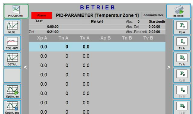
Über die Buttons der linken Sidebar „Optim. an“ und „Optim. aus“ besteht die Möglichkeit, die PID-Parameter über den Programmregler selbständig ermitteln zu lassen (nicht bei jedem Reglertyp möglich). Eine aktivierte Selbstoptimierung wird durch das Kürzel „Opti“ in der Status Anzeige und ein Blinken der Titelzeile verdeutlicht. Zur Gewährleistung brauchbarer Ergebnisse muss der Sollwert während der Optimierung konstant bleiben!
