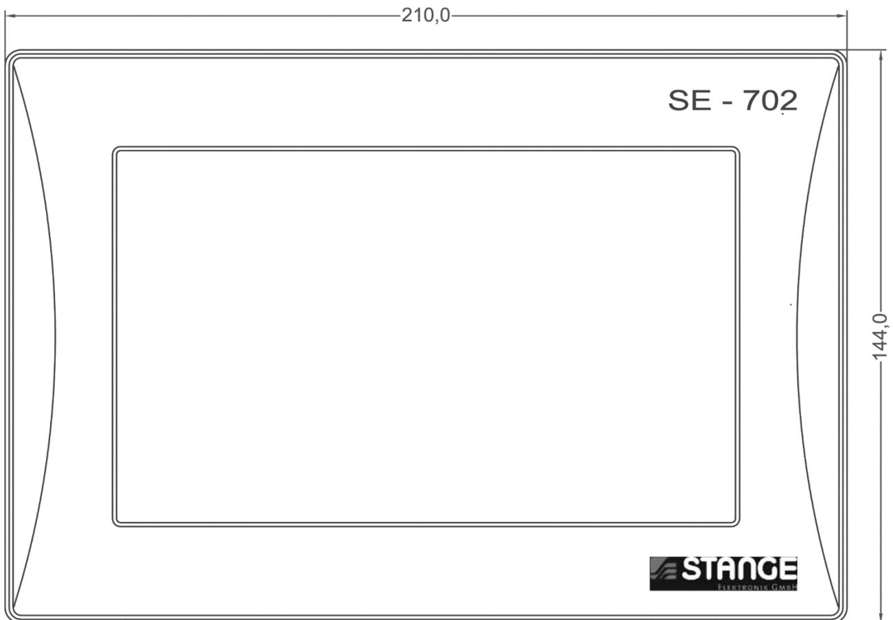
Das Gerät benötigt einen Einbauausschnitt von B x H: 200 mm +/- 0,5 mm x 132 mm +/- 0,5 mm
